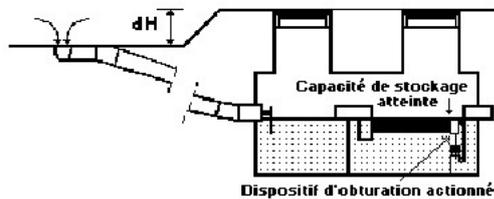
c) Le niveau dans le séparateur continue de monter jusqu'à ce que le niveau du point de captage le plus bas soit atteint. Il convient de fixer une valeur de  $dH$  minimale afin d'éviter un débordement de liquides légers.
