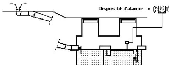
e) Le dispositif d'obturation est actionné. Il y a débordement des liquides légers.
